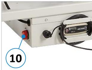
Figure 5 : interrupteur principal
