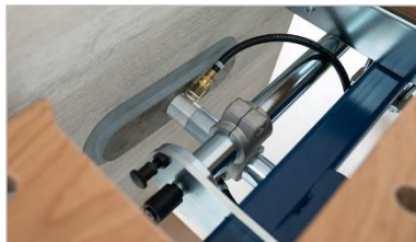
Figure 9 : unité de serrage par le vide
