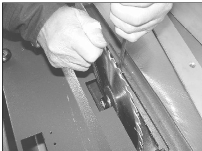
Stecken Sie den Drehstift in die Aufnahmeöffnung hinter dem Sägeblatt.
