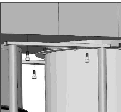
4.2 Den Zyklon-Trichter mit Schraube M8X16 am Laufradgehäuse befestigen.
