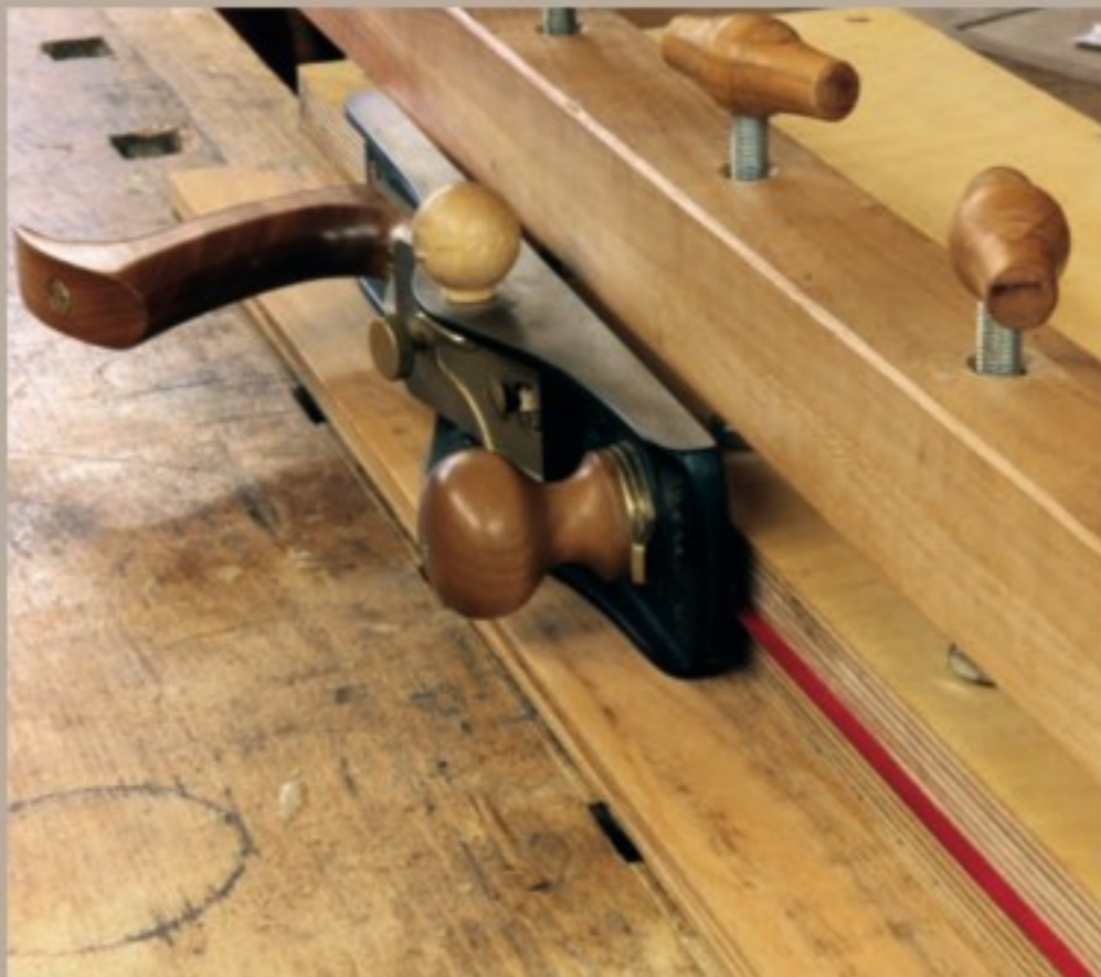
Durch die Zuganker ist garantiert, dass die beiden Klemmplatten im rechten Winkel zur Auflage für den Hobel fluchten.
