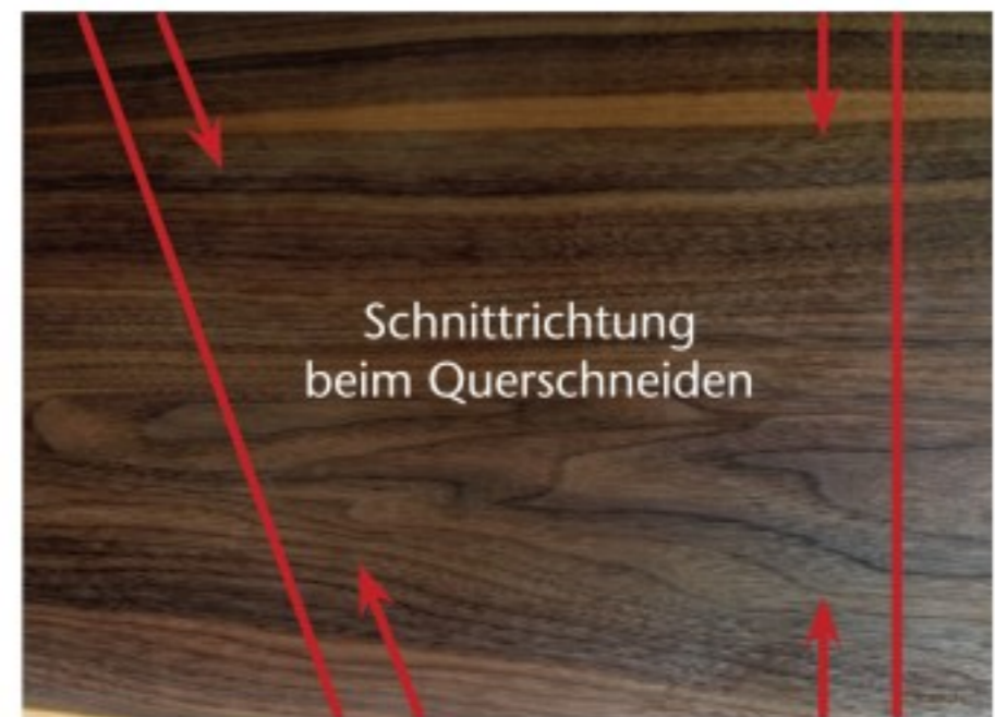
Das Furnier reißt nicht ein, wenn man von außen nach innen schneidet.
