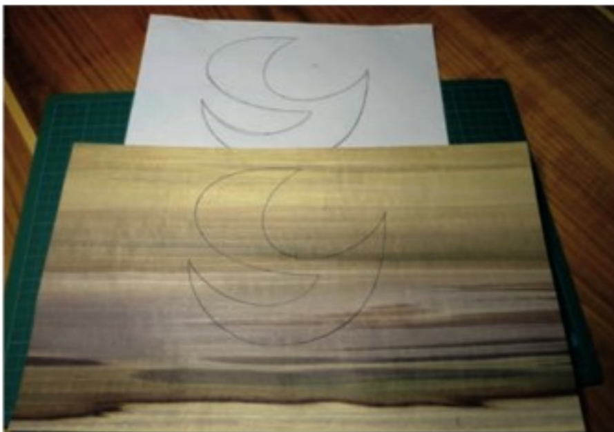
Das Motiv ist mit Kohlepapier auf das Grundfurnier übertragen worden.
