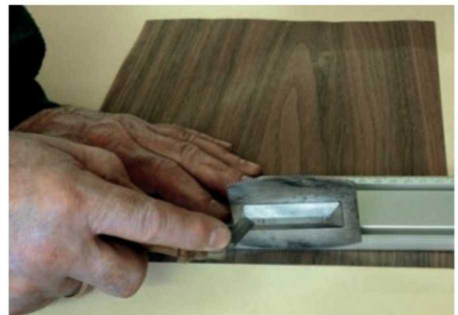
Die große Anlagefläche der Furniersäge ermöglicht einen sauberen Schnitt, ohne Gefahr, durch den Faserverlauf abgelenkt zu werden.
