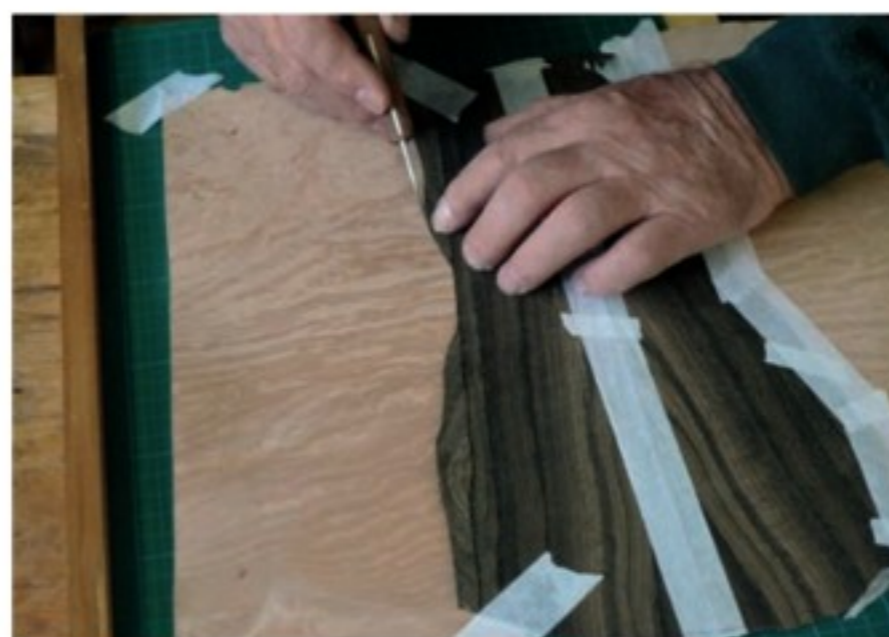
... wird auf das Grundfurnier geheftet und die Kontur mit dem Messer angerissen.
