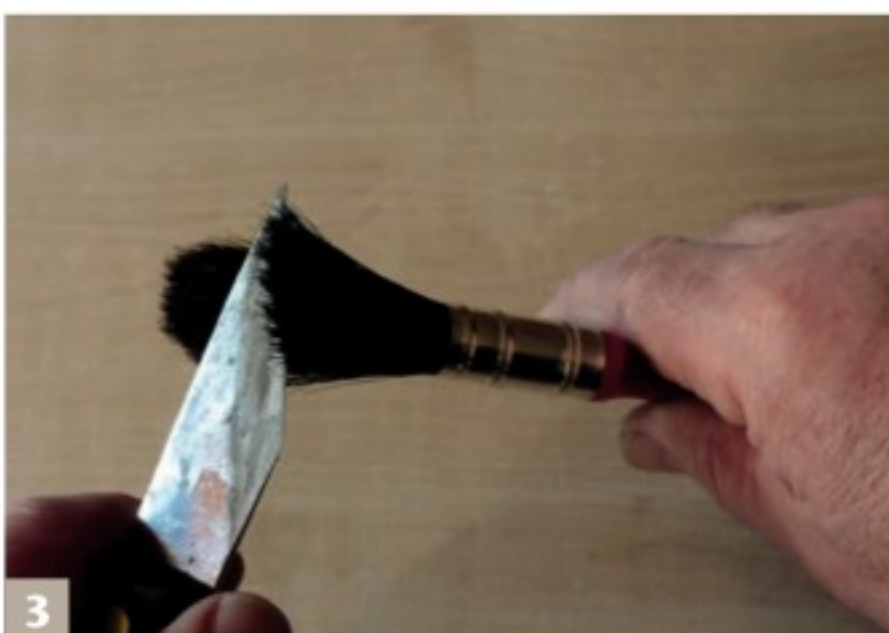
Schneiden von Pinselhaaren ist ein Vergleichsmodell, das zeigt, dass nur beim Schneiden mit der Faserrichtung (Schnittrichtung mit den Haaren) ein sauberer Schnitt entsteht.
