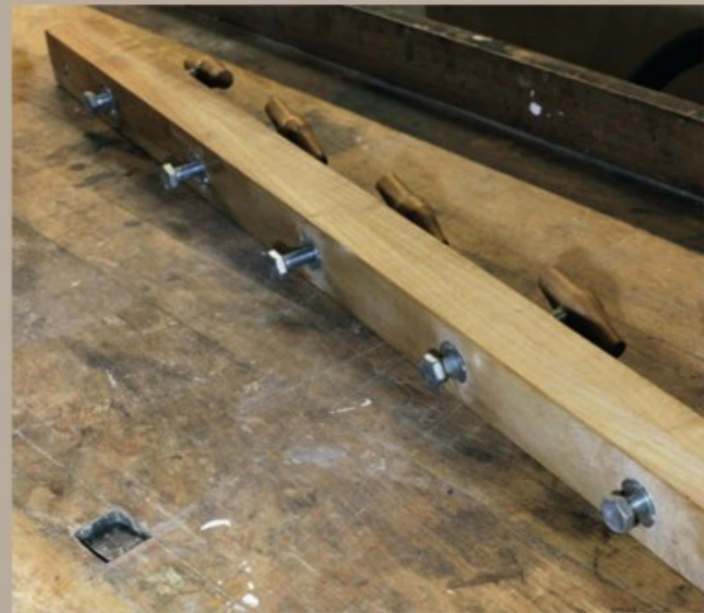
In den Druckbalken sind Einschlagmuttern eingelassen. M10 Schrauben dienen als Druckspindeln. Die Handknebel haben eine 10 mm Sackbohrung, in die die Schrauben mit Epoxidharz verklebt sind.
