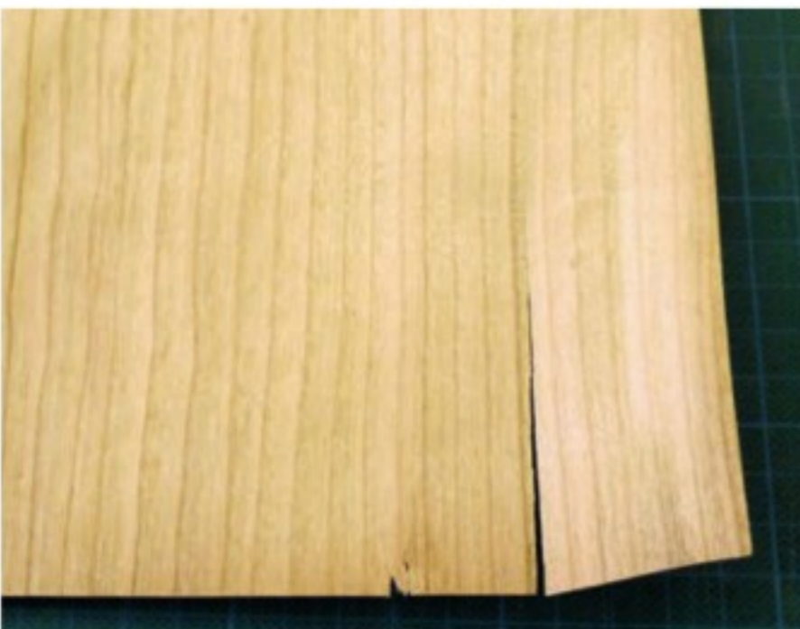
Beim Querschneiden von Furnieren besteht die Gefahr, dass die Holzfasern auseinanderreißen.
