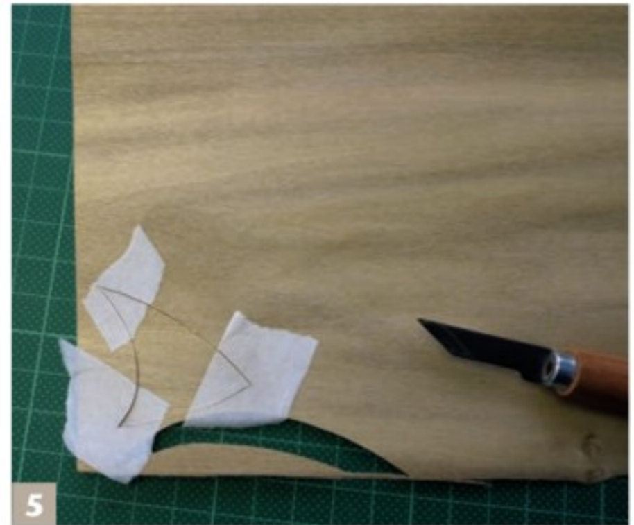
Spitze Ecken schützt man durch Überkleben mit Fugenpapier gegen Ausbrechen.
