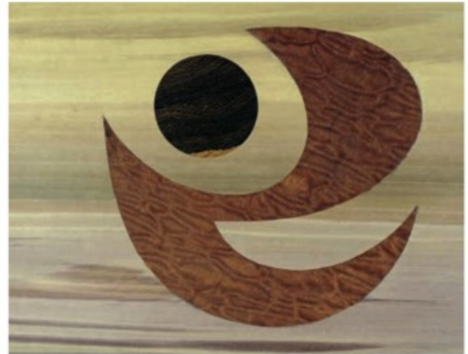
Die ausgeschnittenen Einlagen werden in das Grundfurnier eingepasst. Die Sichtseite liegt jetzt nach oben.
