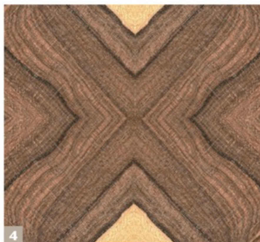
Vier aufeinander folgende Furnierblätter werden unter einem Winkel von 45° zugeschnitten (3) und zu einem quadratischen Furnierbild gefügt (4).
