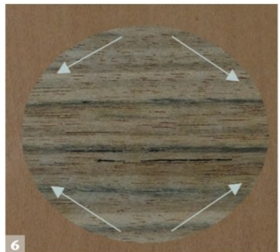
Bei Kreisen werden Viertelkreissegmente jeweils mit der Faser geschnitten.
