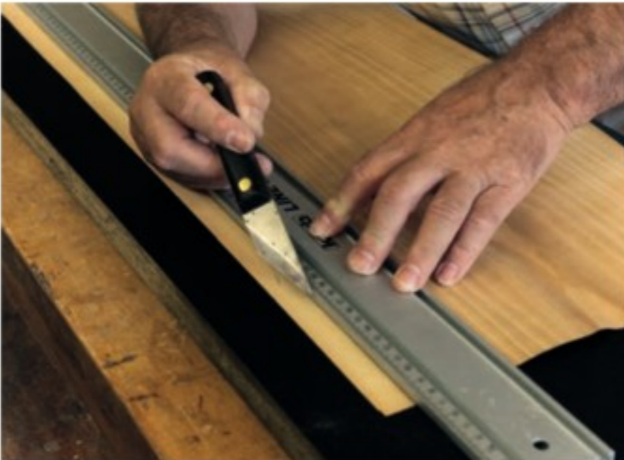
Beim Schneiden zeigt die schräge Seite des Messers immer zum Furnierabfall.
